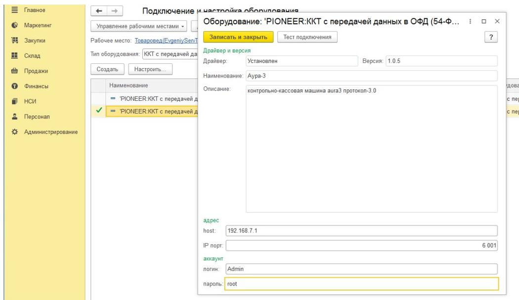
После установки и настройки драйвера Аура3 необходимо привязать оборудование в настройках Кассы.
